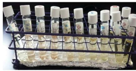
Figura 7. Cuantificación de fenol mediante el método de la 4-aminoantipirina.
